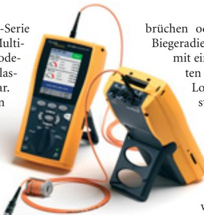
brüchen oder zu engen Biegeradien außerdem mit einem integrierten Visual-Fault-Locator ausgestattet. Hierbei handelt es sich um einen roten Laser, der sichtbar macht, an welcher Stelle eine Glasfaser schadhaft ist, weil dort das rote Licht austritt.
